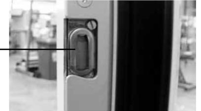
2. Bolzen – ist in der MV integriert
