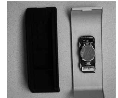
Alte Batterie entnehmen, Neue einsetzen und die Abdeckung aufdrücken.
