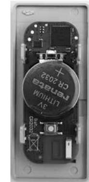
Batterie aus dem Bedienteil entnehmen, Neue einsetzen, Cover wieder aufsetzen und nach unten schieben.
