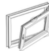
Lassen Sie den Fenstergriff in Kippstellung, drücken Sie den Flügel auf der Scherenseite an den Rahmen und drehen Sie den Griff (90°) in die Drehstellung.
