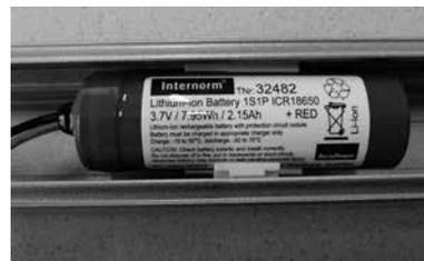
Den Akku aus der Halterung entfernen. Neuen Akku einbauen, den Stecker in die Platine einstecken. Dabei darauf achten, dass das Kabel seitlich nicht mit der drehenden Welle in Berührung kommt.
